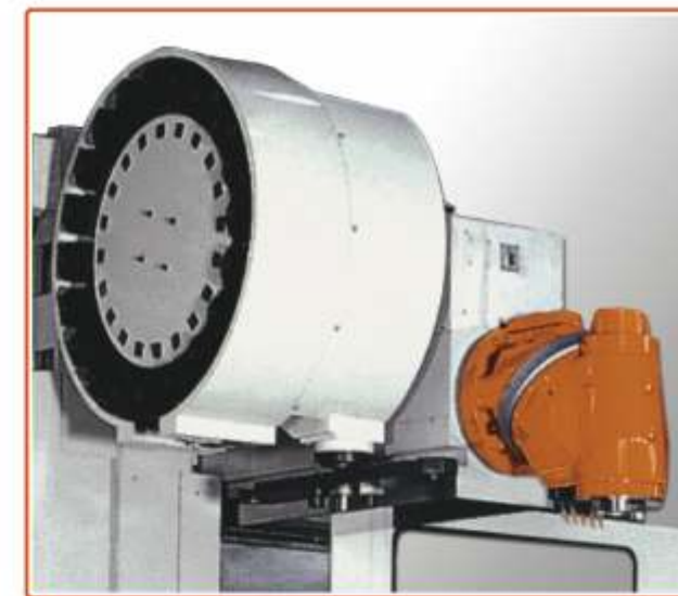
▲ CAMBIA UTENSILE AUTOMATICO A RUOTA A 12, 20, 24 POSTI
