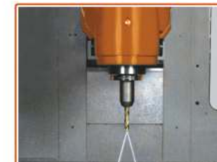
▲ PASSAGGIO LIQUIDO REFRIGERANTE ATTRAVERSO IL MANDRINO
